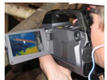
4.3"高对比度彩色LCD可旋转显示屏，允许您更加安全地从任一角度观测目标物，避免因长时间不恰当的用眼而产生视觉疲劳。
